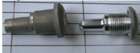
Abb. Unten: Der Rohling und das fertige Drehteil (dreh007bm2.jpg)
