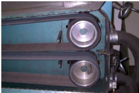
Abbildung 1: Blick in die geöffnete Bandschleifmaschine, die 2 Düsen sind mittig rechts schleif05am.pg
