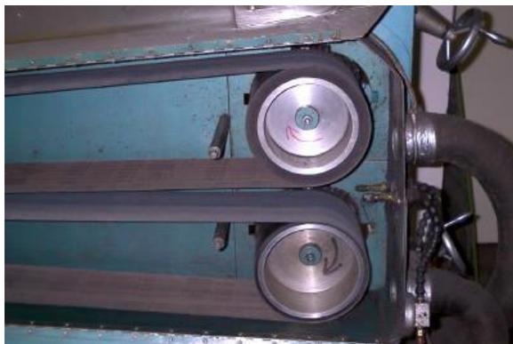
Abbildung 1: Blick in die geöffnete Bandschleifmaschine, die 2 Düsen sind mittig rechts
