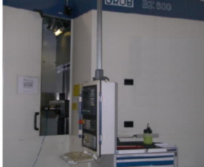
Abbildung: Das Bearbeitungszentrum GROB BZ600, im Innenraum die Spindel (center03mm.jpg)
