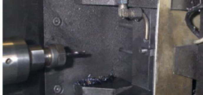
Abbildung: Links der Bohrer in der Vorschubeinheit, von oben kommend die Düse und die doppelt abgewinkelte Vorrichtung (bohr019m2.jpg)
