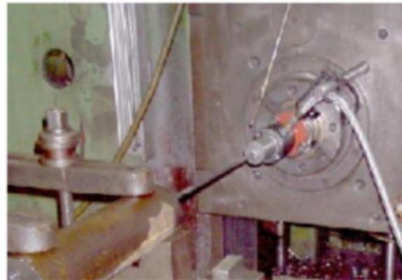
Abbildung: Rechts die Düse des T70a angeschraubt an der Adapteraufnahme, mittig taucht der Bohrer in das Werkstück ein. (bohr020m.jpg)
