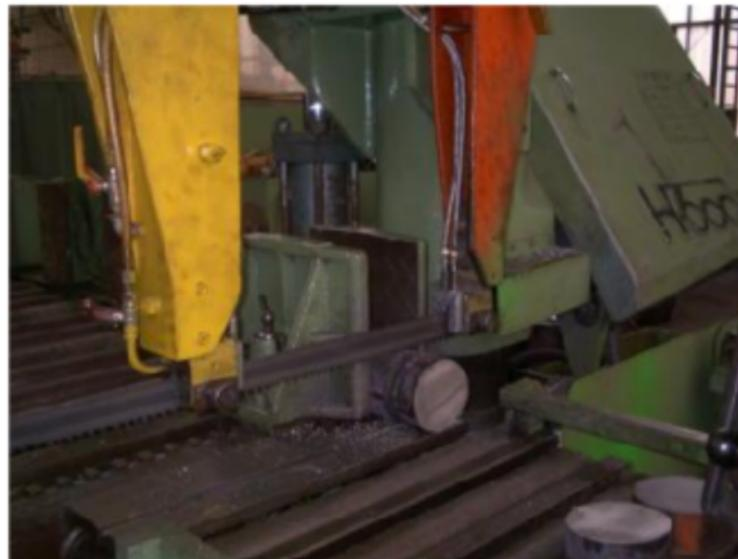
Abb.: Bandsäge AMADA H-600 mit MMKS (saeg22m.jpg)
