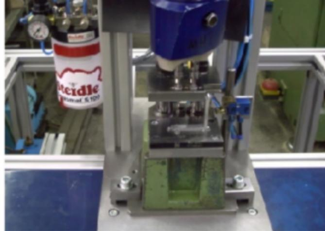
Abb.: Mittig der Doppelspindler und die Führungshülsen, dahinter verdeckt die Düsen des S100/2. (bohr024m.jpg)
