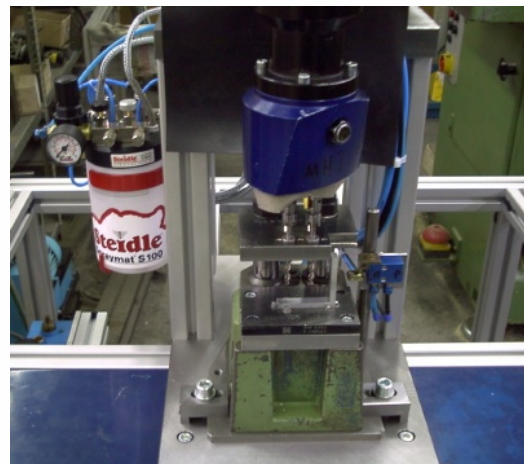
Abb.: Mittig der Doppelspindel und die Führungshülsen, dahinter verdeckt die Düsen des S100/2. (bohr024m.jpg)
