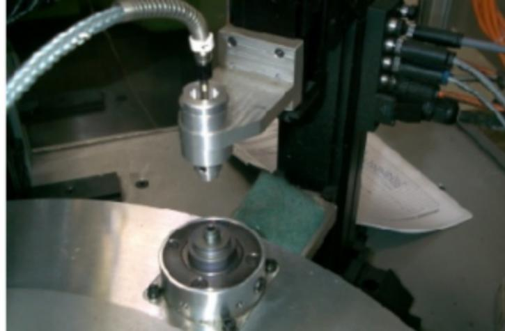
Abb.: Unten das Werkstück, das mit der Düse (mittig) besprüht wird (kalib02m.jpg)
