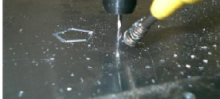
Abb.: Mittig der Hartmetallfräser, links die Düse des S100
