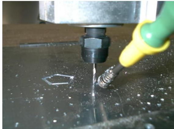
Abb.: Mittig der Hartmetallfräser, links die Düse des S100
