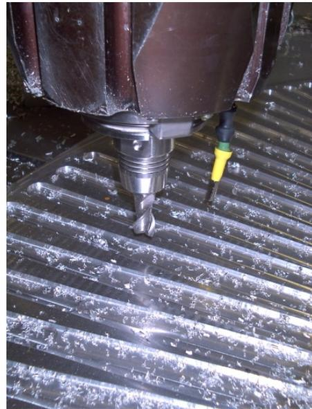
Abbildung: Rechts die Düse, aus dem der T70a sprüht.
