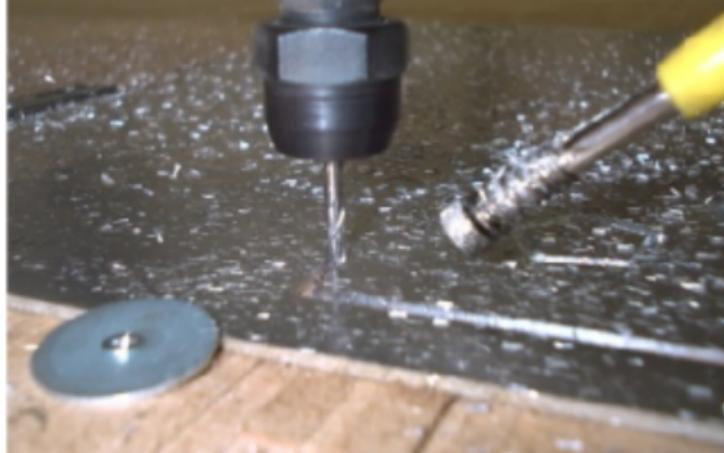
Abb.: Mittig der Hartmetallfräser, rechts die Düse des S100
