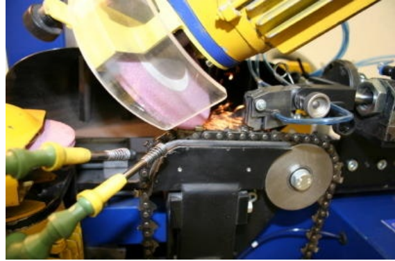
Abb.: Mittig die Schleifscheibe und die Kette, links die Düsen des S100 (schleif06m.jpg)
