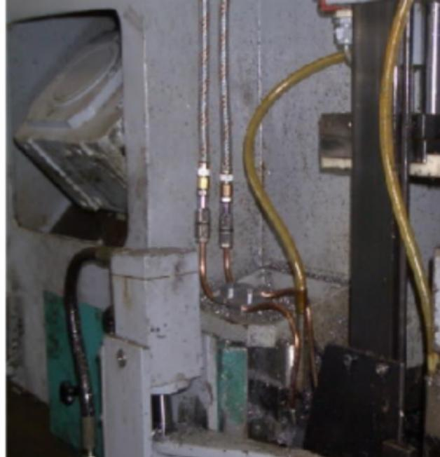
Abb.: Verlegung der 2 Düsen an der Bandsäge
