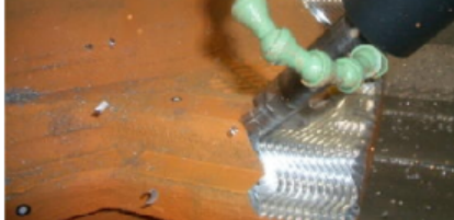
Abb.: Schruppen in Aluminium mit MMKS (fraes29m.jpg)
