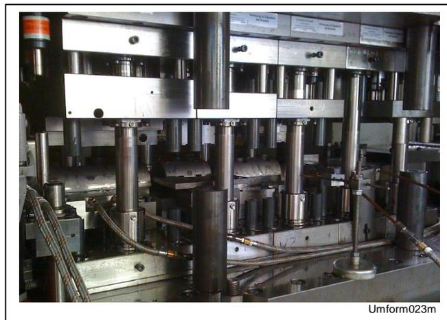
Im Verlauf der aktuellen Produktion hat sich gezeigt, dass die Dosierbarkeit der Ölmenge an den kritischen Stellen im Werkzeug entscheidend zur Prozesssicherheit beiträgt und somit die Standzeit des Werkzeugs garantiert.
