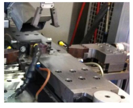
Die Lochkreissägen werden in Größen von Durchmesser 20-48mm hergestellt, wobei entsprechendes Flachmaterial gebogen werden muss. Dafür wurde eine Sondermaschine gebaut.
