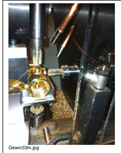
Daher hat man eine Maschine konstruiert, auf der die Teile in einer Aufspannung bearbeitet werden. Durch die Anbringung von Sicherheitsvorrichtungen kann das Schmiermittel nicht mehr von Hand aufgetragen werden. Ohne Schmiermittel geht es aber nicht.
