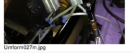
Also suchte man nach einer genaueren und prozesssicheren Lösung. Da man schon in 5 verschiedenen Abteilungen im Hause Steidle Geräte einsetzt, kam man auf uns zu. Mit einem Lubrimat L60/1 wurde das wässrige Schmiermittel auf die Rohteile in der Materialzufuhr aufgesprüht. Wegen der geringen Viskosität wurde der Zuführschlauch mit einer Querschnittsverengung verwendet (ZMQ...).
