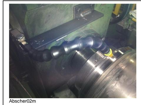
Über den Zeitraum von vier Wochen sah man deutliche Unterschiede. Während die Messer der Tropfölerseite sechs Mal getauscht werden mussten, benötigte die Seite mit dem Lubrimat L60 nur zwei Wechsel. Neben der Steigerung der Standzeit auf 300% wurde zusätzlich die eingesetzte Mediummenge auf Anhub um über 70% reduziert.
