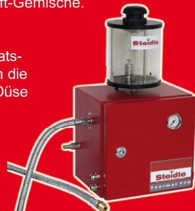
Beim Toolmat® T70 sorgen die bewährten Kolbenpumpen für eine genau wählbare Fördermenge. Über die Sprühluft kann der Grad der Zerstäubung beeinflusst werden. Mit der Mantelluft kann man die Sättigung des Gemisches einstellen. In den Versionen Vario3 oder Vario7 können 3 oder 7 voreinstellbare Ölmengen abgerufen werden.
