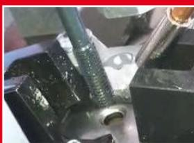
**Gewindeformen** von M8- und M6-Gewinden in Montageplatten aus V2A. Bei der direkt mit MMKS geplanten Anlage konnte die vorgegebene Werkzeugstandzeit um 33% überschritten werden.
