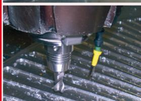
**Fräsen** von Musterlehren aus Kunststoff oder Aluminium auf einer Zimmermann FZ 40 5-Achs-Portalfräsmaschine. Dabei wird mit einem MMKS-System für die innere Zuführung das Öl-Luftgemisch durch einen seitlichen Kühlkanal der Spindel geleitet und durch eine Gliederschlauchdüse aufgesprüht. Mit der getrennt ansteuerbaren Blasluftfunktion werden zudem bei Bedarf Späne aus dem Arbeitsbereich entfernt.
