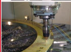
**Gewindeformen** von M36 in Rotorringen für Windkraftwerke. Die Ringe mit bis zu 6m Durchmesser sind aus hochwertig geschmiedetem Stahl. Da eine hohe Maßhaltigkeit verlangt wird, darf sich das Werkstück nicht stark erwärmen. Um den dazu nötigen Kühleffekt zu erzielen, wird hier bewusst mit mehr Ölmenge gearbeitet, als man es sonst bei MMKS gewöhnt ist.
