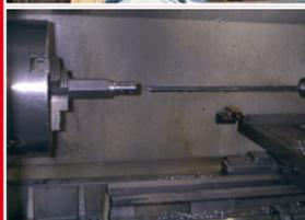
**Tieflochbohren** von Ø13mm bis zu einer Tiefe von 400mm. Bedingt durch einen guten Spanbruch und das bei MMKS geringere Eigengewicht der trockenen Späne lassen sich diese leichter aus der Bohrung fördern. So bleiben die Werkstücke, die nur 70mm im Durchmesser haben, kühl.
