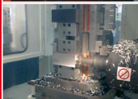
**Fräsen und Bohren** auf einem BAZ in Aluminium. MMKS mit innerer Zuführung durch Spindel und innengekühltem Werkzeug.
