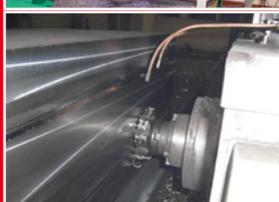
**Fräsen** von 3m langen, geschmiedeten Stahlblöcken aus X4CrNiMo16-5-1. Es wird die Zunderschicht abgetragen und der Block auf Maß gebracht. Mit MMKS konnte man gegenüber der Trockenbearbeitung die Werkzeugstandzeit erhöhen. Zudem reduzierte sich die Bearbeitungszeit um 2 ½ Stunden pro Block, da die Zustellung und der Vorschub erhöht werden konnten.
