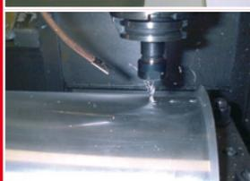
**Bohren** Ø 4 mm in Aluminium-Walzen (Ø 250 mm) auf einem BAZ. Die Löcher müssen trocken sein, da danach Kegelstifte eingeklebt werden. Bei Nutzung der Umlaufkühlung musste man daher extra die Emulsion auf einer Drehmaschine ausschleudern. Mit MMKS schmiert eine Düse den Bohrer. Die Bohrungen sind trocken, das Ausschleudern kann entfallen.
