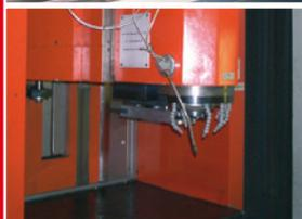
**Fräsen** von Kunststoffteilen auf einem BAZ. Da eine Emulsion den Kunststoff angegriffen hätte, wurde bisher trocken gearbeitet. Dadurch war die Oberflächenqualität oft nicht gut. Mit einer Düse wird nun der Fräsprozess geschmiert. Die Oberflächenqualität konnte verbessert werden. Je nach Kunststoffsorte kann sogar ein Glanzeffekt erzielt werden.
