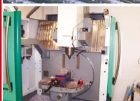
**Fräsen** von Einzelstücken diverser Materialarten auf einer DMG 50T in der mechanischen Werkstatt eines Instituts. Gegenüber der vorherigen Trockenbearbeitung konnte die Standzeit der Werkzeuge entschieden verbessert werden.
