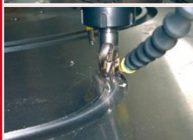
**Fräsen** von Ring-T-Nuten in Planscheiben (Ø bis zu 3.000 mm) aus St52. Wegen der Größe der Teile und der offenen Konstruktion ist keine Umlaufkühlung möglich. Zwei Düsen schmieren den Fräser. Die Standzeit stieg gegenüber der Trockenbearbeitung um 100%.
